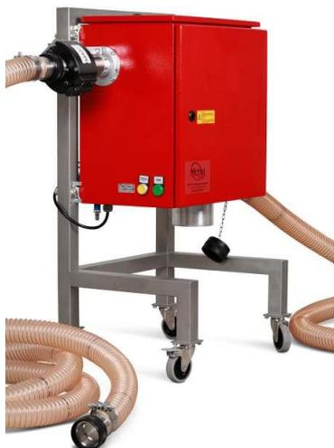
Die produktspezifische Detektionsleistung wird manuell oder mit digitaler Auswertelektronik automatisch eingestellt.
